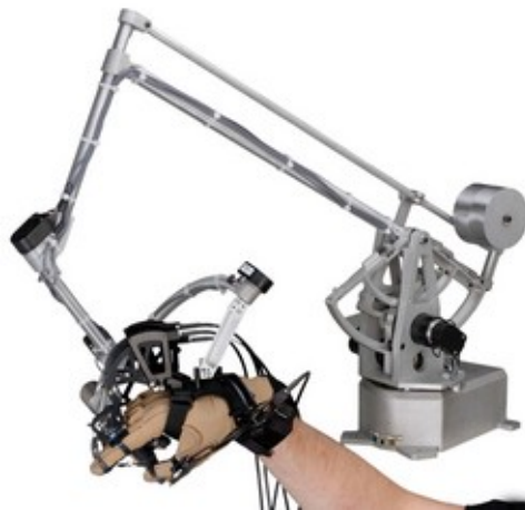
Figura 1: Na imagem pode-se observar a Cyber-Glove vestida, o CyberGrasp envolta da mão do usuário e o braço do CyberForce conectado aos Artefatos
